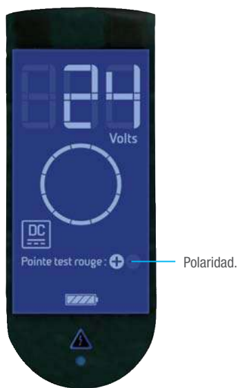
Ejemplo de detección continua de 24 V, visualización en AZUL porque < 50 V.
