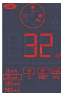
Ejemplo de medida de la corriente de disparo 30 mA no conforme (valor de corriente > al umbral).
