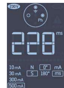
Ejemplo de medida del tiempo de disparo de un DDR 500 mA conforme.
